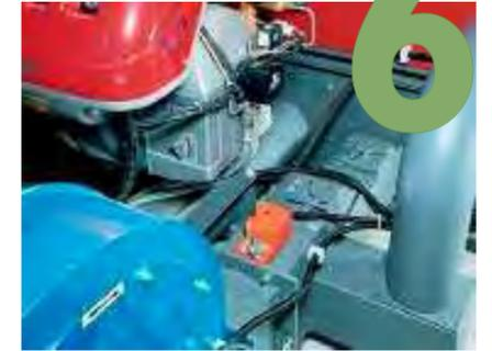
Colector de encauzamiento del aire de combustión primario y secundario con registros manuales de regulación y registro automático de cierre total.
