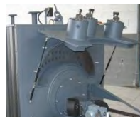
Limpieza del intercambiador
