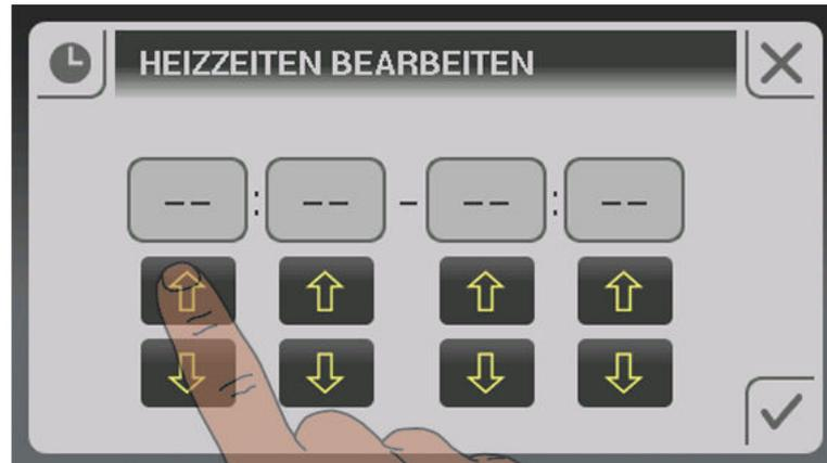
Para borrar una franja horaria, ajuste las horas de tal modo que los indicadores de horas y minutos queden sustituidos por dos rayas.
