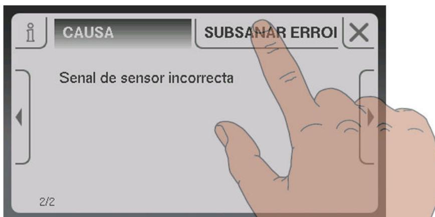
Por otro lado, pulsando en "Subsanar error" se accede a procedimientos para solucionar el error. Si hay varias posibilidades, estas se muestran una debajo de la otra.
