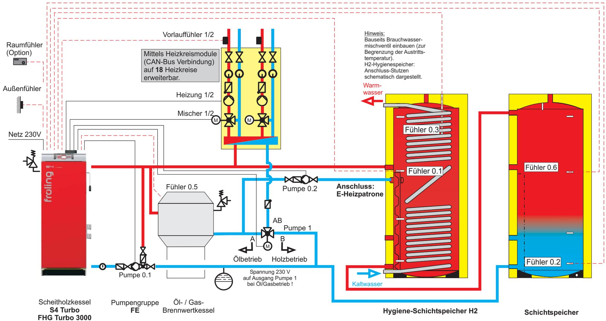
**Hinweis:** Im Menü KESSEL 2 unter Punkt SERVICE den Parameter WELCHER AUSGANG WIRD FÜR FOLGEKESSEL ENTLADUNG VERWENDET auf "PUMPE 1" stellen!
