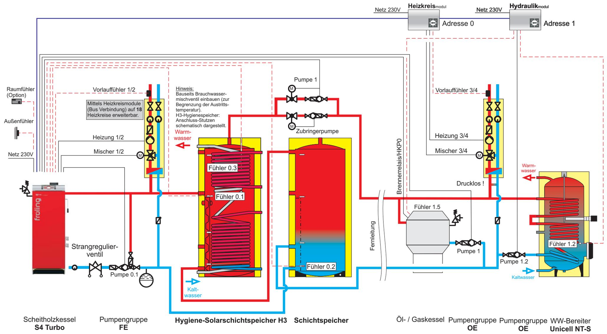
**Hinweis:** Im Menü KESSEL 2 unter Punkt SERVICE den Parameter WELCHER AUSGANG WIRD FÜR DIE FOLGEKESSELENTLADUNG VERWENDET auf "Pumpe 1" stellen!
