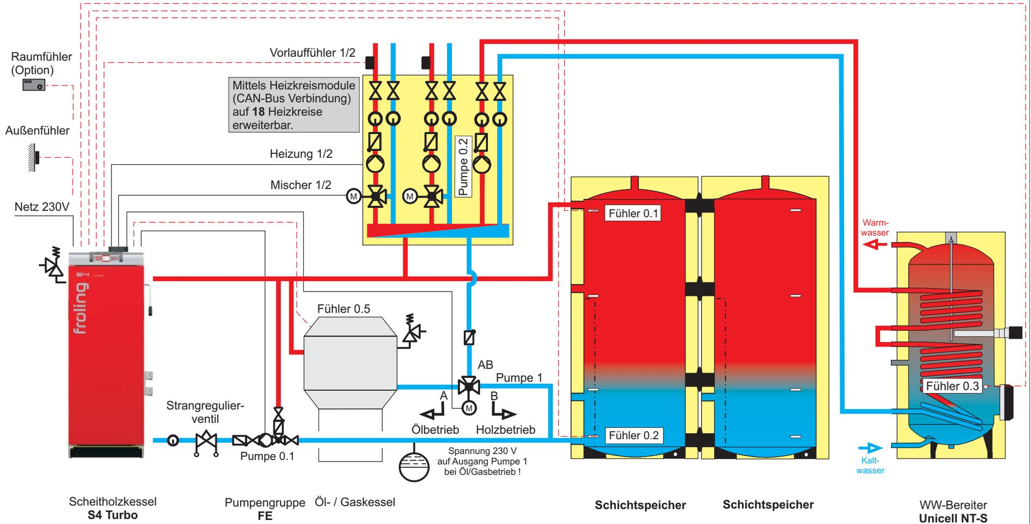
**Hinweis:** Im Menü KESSEL 2 unter Punkt SERVICE den Parameter WELCHER AUSGANG WIRD FÜR DIE FOLGEKESSELENTLADUNG VERWENDET auf "Pumpe 1" stellen!
