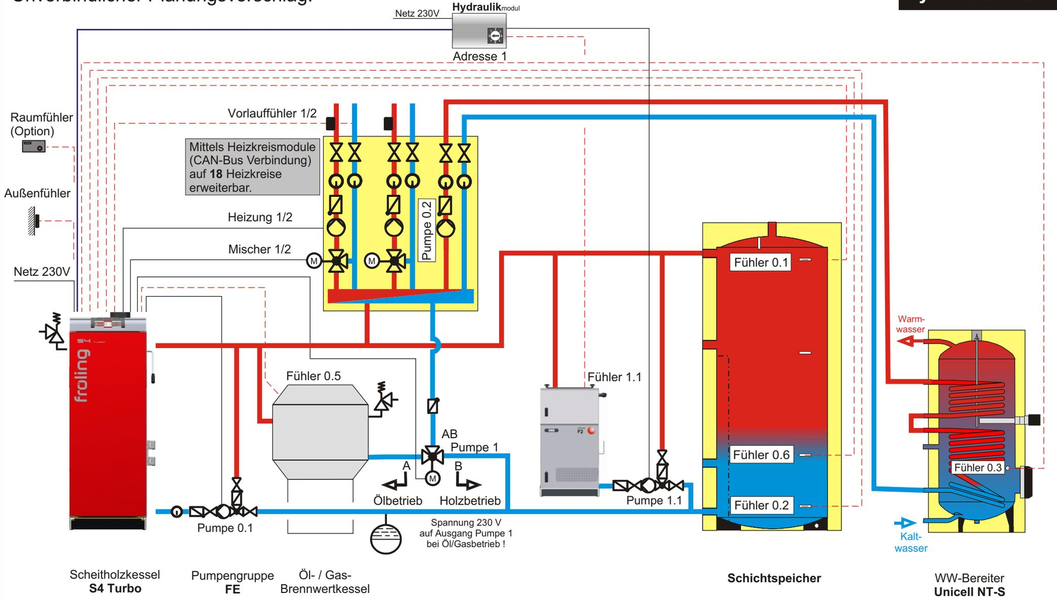
**Hinweis:** Im Menü DIFF. REGLER bei Einstellpunkt SERVICE die Parameter WELCHER FÜHLER WIRD FÜR DIE WÄRMEQUELLE VERWENDET auf "1.1", WELCHER FÜHLER WIRD FÜR DIE WÄRMESENKE VERWENDET auf "0.2", WELCHE PUMPE WIRD VERWENDET auf "1.1"
