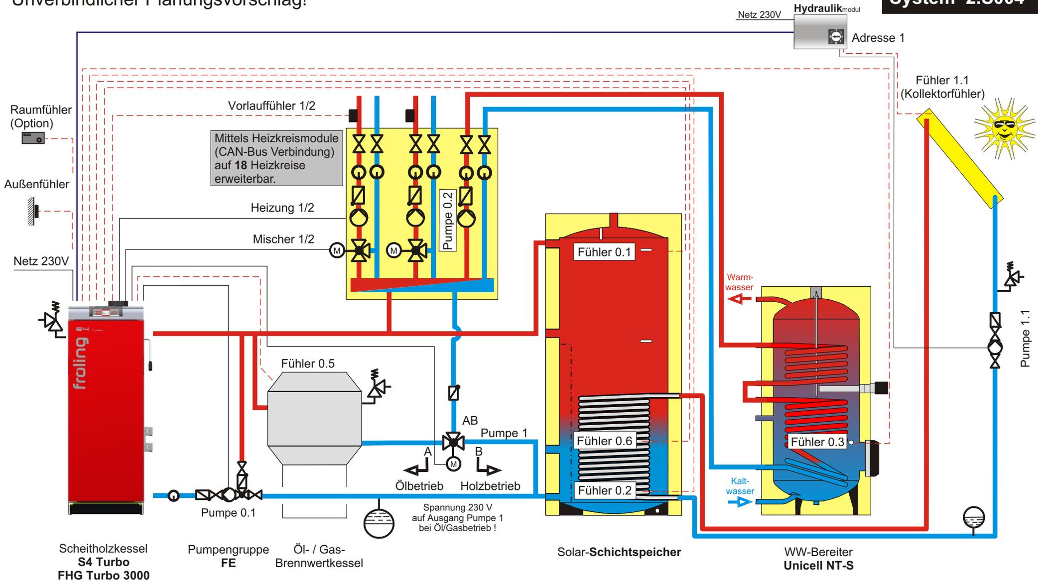
**Hinweis:** Im Menü KESSEL 2 unter Punkt SERVICE den Parameter WELCHER AUSGANG WIRD FÜR DIE FOLGEKESSELENTLADUNG VERWENDET auf "Pumpe 1" stellen. Im Menü SOLAR bei Einstellpunkt SERVICE den Parameter SOLAR SYSTEM auf "2" und WELCHER FÜHLER WIRD FÜR DIE PUFFER-REFERENZ VERWENDET auf "0.6" stellen! Regelung S3200
