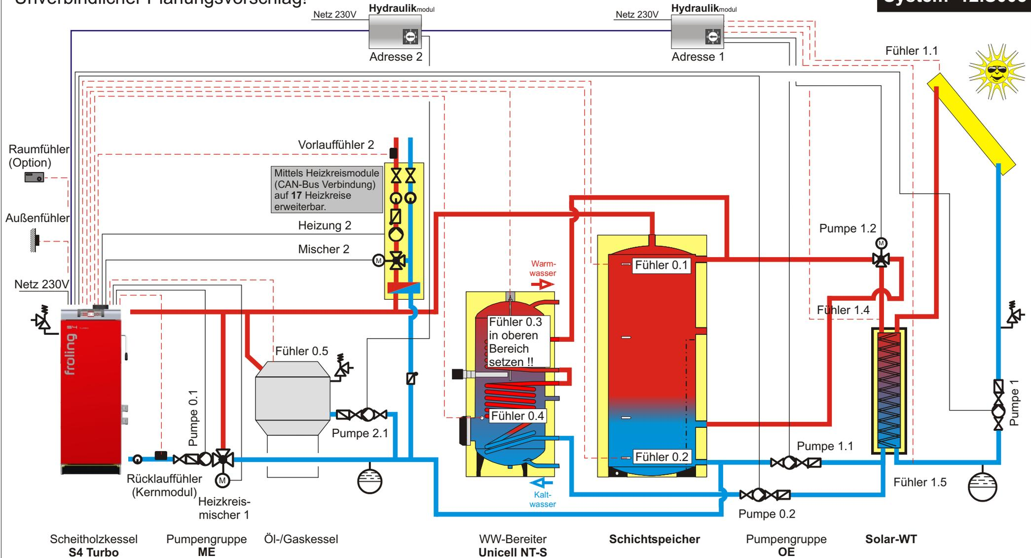
**Hinweis:** Im Menü KESSEL 2 unter Einstellpunkt SERVICE den Parameter WELCHER AUSGANG WIRD FÜR DIE FOLGEKESSELENTLADUNG VERWENDET auf "2.1" stellen.
