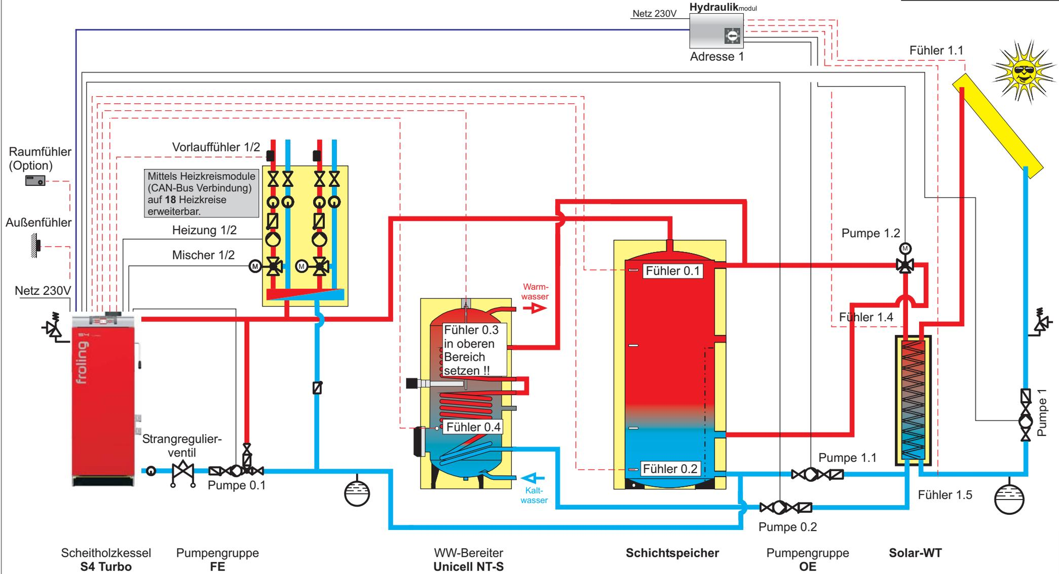
**Hinweis:** Im Menü SOLAR unter Einstellpunkt SERVICE den Parameter WELCHE PUMPE WIRD FÜR DEN SOLARKOLLEKTOR VERWENDET auf "Pumpe 1", WELCHE PUMPE WIRD FÜR DAS SOLARUMSCHALTVENTIL VERWENDET auf "1.2", WELCHE PUMPE WIRD FÜR PUFFER - WÄRMETAUSCHER VERWENDET auf "1.1", WELCHE PUMPE WIRD FÜR BOILER - WÄRMETAUSCHER VERWENDET auf "0.2" stellen
