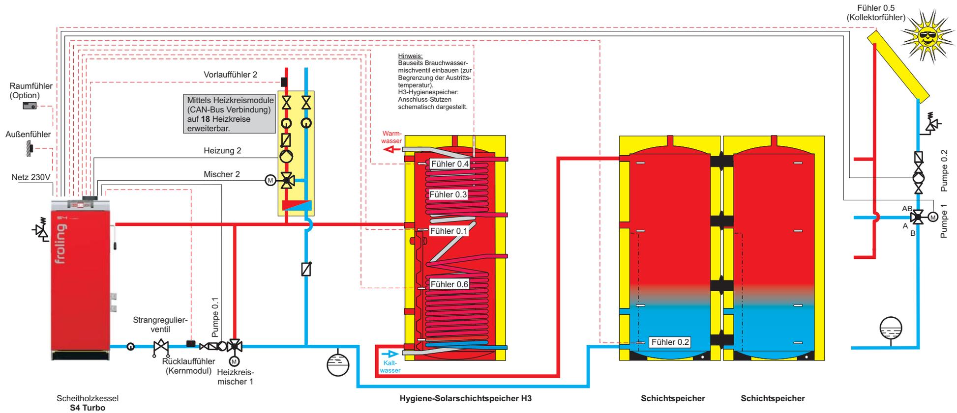
**Hinweis:** Im Menü SOLAR bei Einstellpunkt SERVICE die Parameter SOLAR SYSTEM auf "3", WELCHER FÜHLER WIRD FÜR DIE PUFFERREFERENZ VERWENDET auf "0.6", WELCHER FÜHLER WIRD FÜR DEN KOLLEKTOR VERWENDET auf "0.5", WELCHE PUMPE WIRD FÜR DEN KOLLEKTOR VERWENDET auf "0.2" und WELCHE PUMPE WIRD FÜR DAS SOLARUMSCHALTVENTIL VERWENDET auf "PUMPE 1" stellen. Regelung S3200
