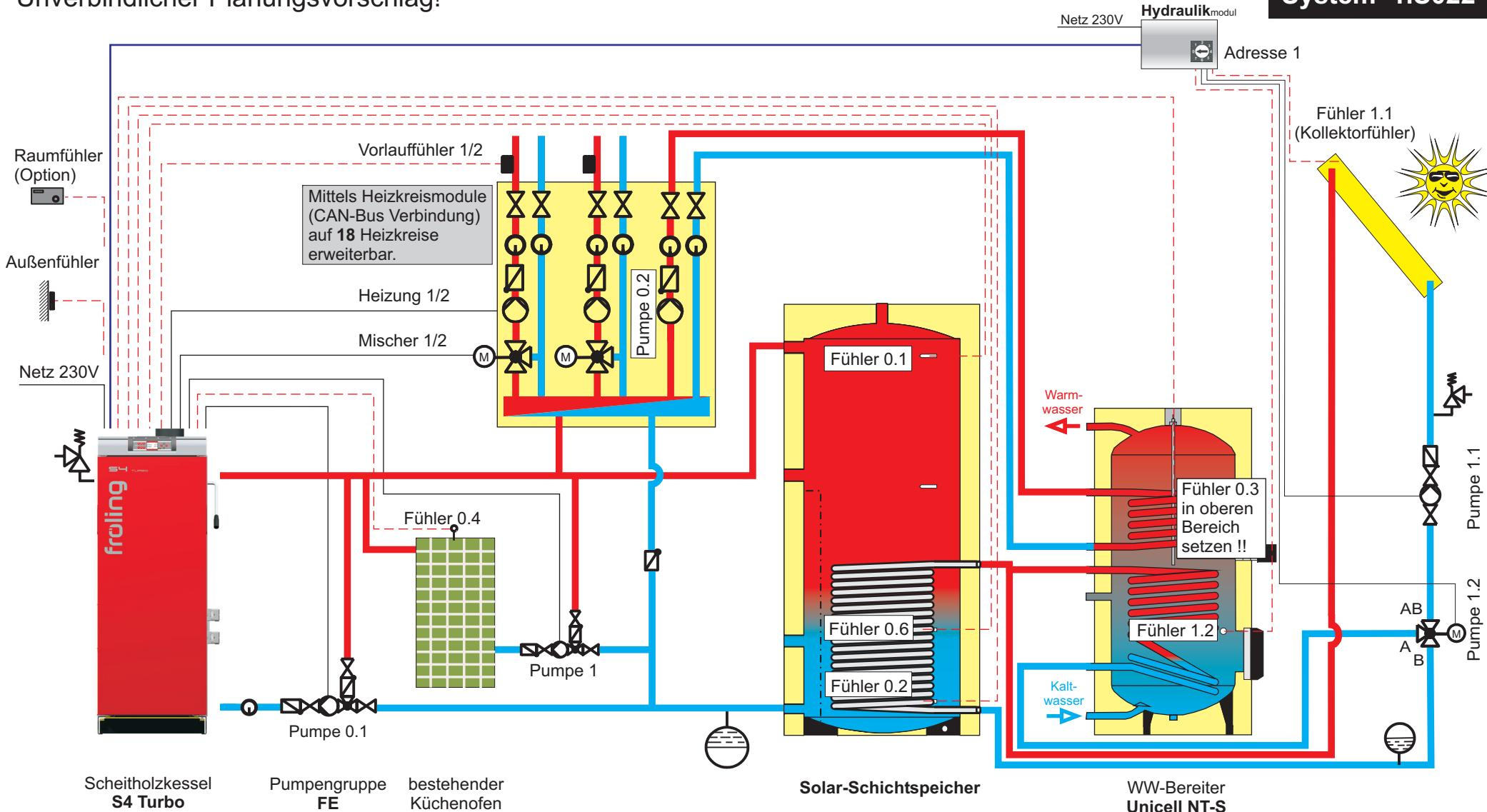
**Hinweis:** Im Menü DIFF. REGLER unter Einstellpunkt SERVICE den Parameter WELCHER FÜHLER WIRD FÜR DIE WÄRMEQUELLE VERWENDET auf "0.4", WELCHER FÜHLER WIRD FÜR DIE WÄRMESENKE VERWENDET auf "0.2", WELCHE PUMPE WIRD VERWENDET auf "Pumpe 1" stellen. Im Menü SOLAR bei Einstellpunkt SERVICE den Parameter SOLAR SYSTEM auf "3", WELCHER FÜHLER WIRD FÜR DEN BOILER UNTER VERWENDET auf "1.2", WELCHER FÜHLER WIRD FÜR DIE PUFFERREFERNZ VERWENDET auf "0.6" stellen! Regelung S3200
