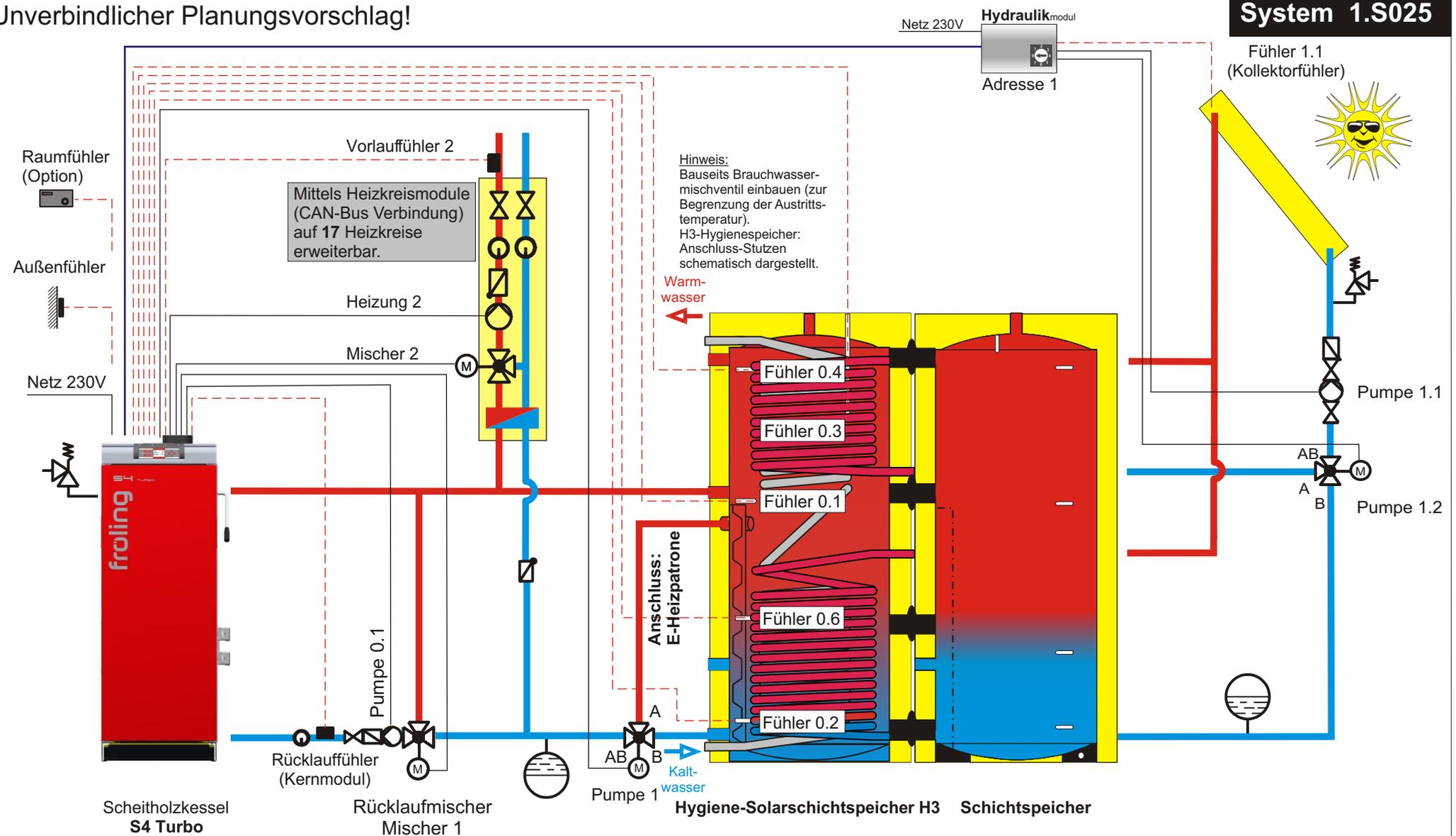
**Hinweis:** Im Menü BOILER 01 bei Einstellpunkt SERVICE den Parameter WELCHER FÜHLER WIRD FÜR DIE BOILER 01 SOLARREFERENZ VERWENDET auf "0.4" setzen.
