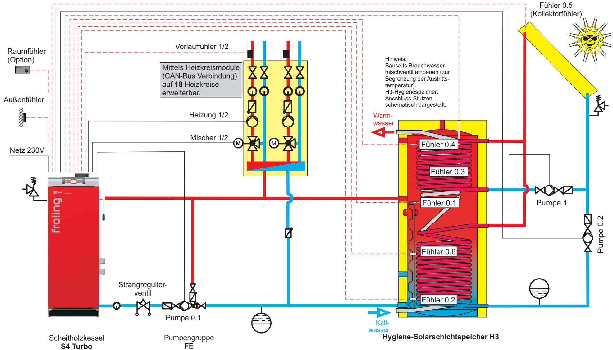
**Hinweis:** Im Menü SOLAR bei Einstellpunkt SERVICE die Parameter SOLAR SYSTEM auf "3", WELCHER FÜHLER WIRD FÜR DEN SOLARKOLLEKTOR VERWENDET auf "0.5", WELCHER FÜHLER WIRD FÜR DIE PUFFERREFERENZ VERWENDET auf "0.6", WELCHE PUMPE WIRD FÜR KOLLEKTOR - PUFFER VERWENDET auf "0.2", WELCHE PUMPE WIRD FÜR KOLLEKTOR - BOILER VERWENDET auf "Pumpe 1" stellen. Regelung S3200. Ab Softwareversion V50.04 B05.02
