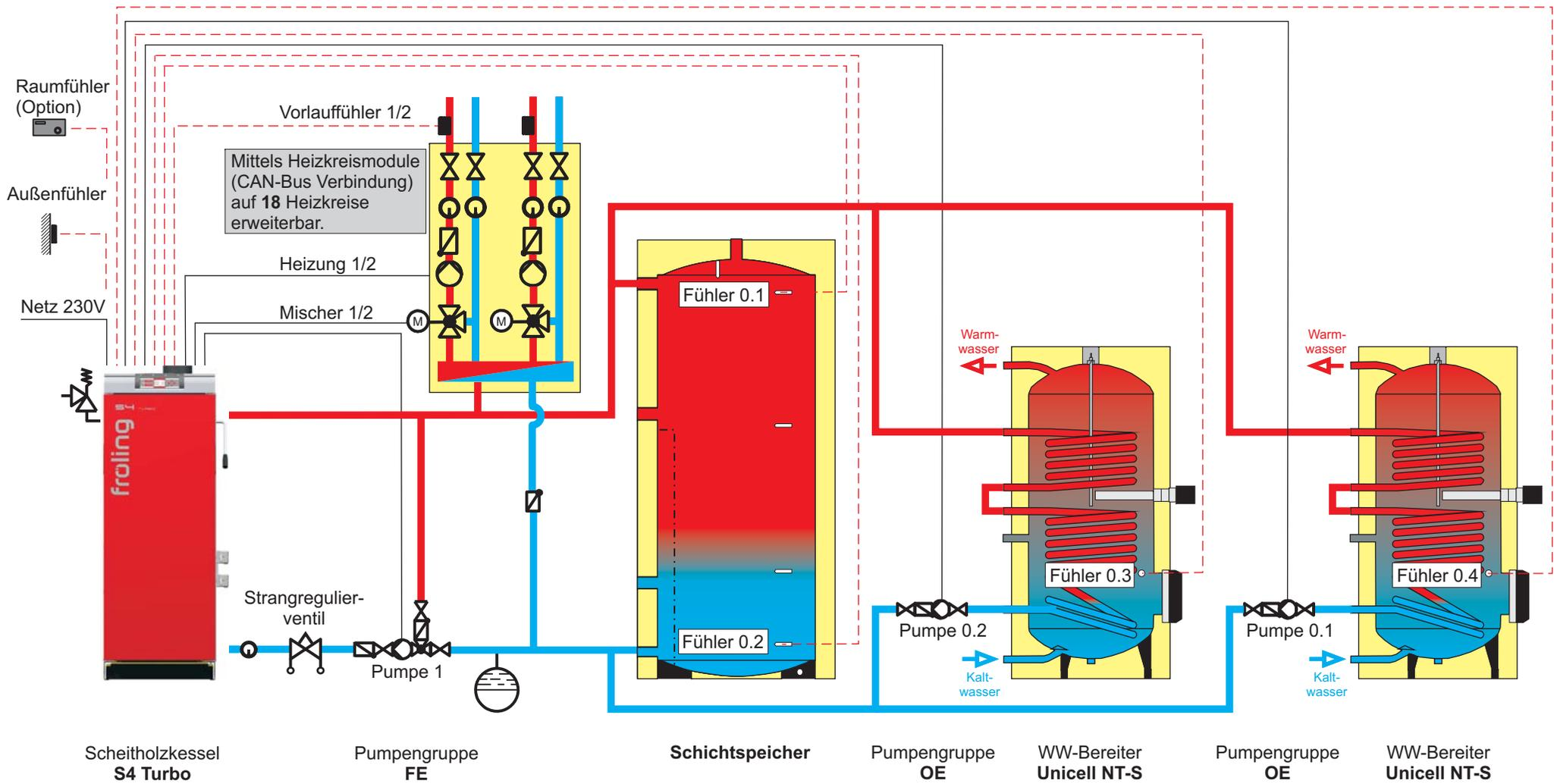
**Hinweis:** Im Menü FÜHLER UND PUMPEN den Parameter WELCHE PUMPE WIRD FÜR DEN PUFFER VERWENDET auf "Pumpe 1" stellen.
