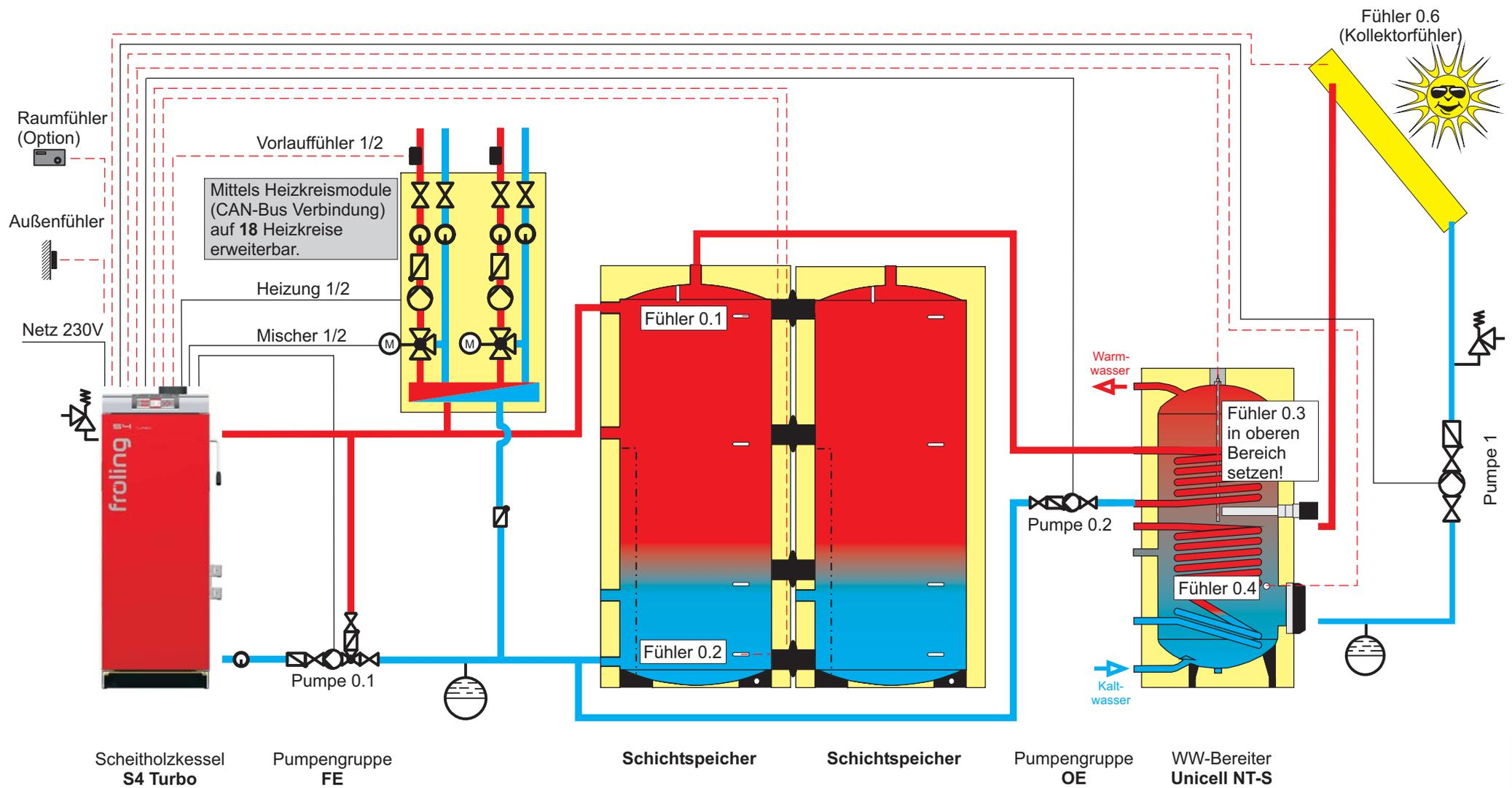
**Hinweis:** Im Menü SOLAR bei Einstellpunkt SERVICE die Parameter SOLAR SYSTEM auf "1", WELCHER FÜHLER WIRD FÜR DEN SOLARKOLLEKTOR VERWENDET auf "0.6" und WELCHE PUMPE WIRD FÜR DEN SOLARKOLLEKTOR VERWENDET auf "Pumpe 1" stellen. Regelung S3200
