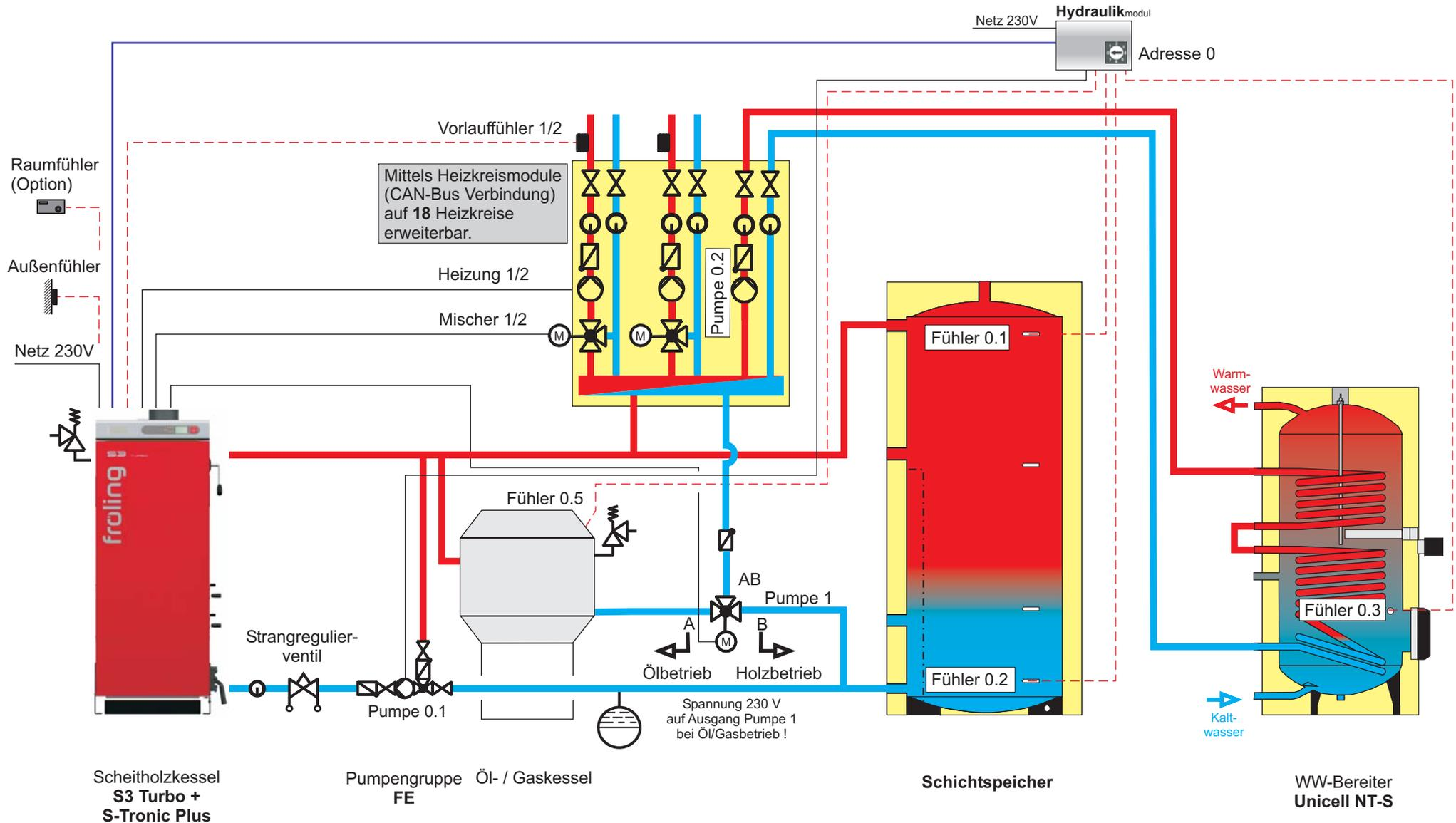
**Hinweis:** Im Menü Puffer unter Punkt SERVICE den Parameter WELCHE PUMPE WIRD FÜR DEN PUFFER VERWENDET auf "0.1" stellen.
