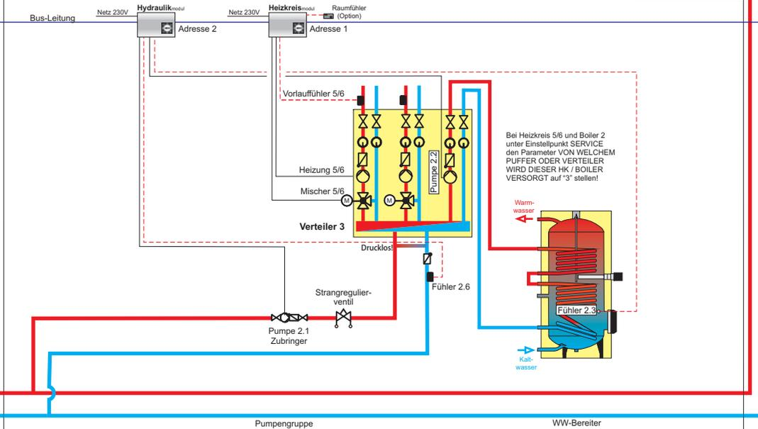
**Hinweis:** Im Menü NETZ PUMPE unter Punkt SERVICE den Parameter WELCHER FÜHLER WIRD FÜR DEN VERTEILER 3 VERWENDET auf "2.1" stellen. Im Menü WASSER bei BOILER 2 unter Einstellpunkt SERVICE den Parameter WELCHER FÜHLER WIRD FÜR DEN BOILER 2 VERWENDET auf "2.3", WELCHE PUMPE WIRD FÜR DEN BOILER 2 VERWENDET auf "2.2" stellen.
