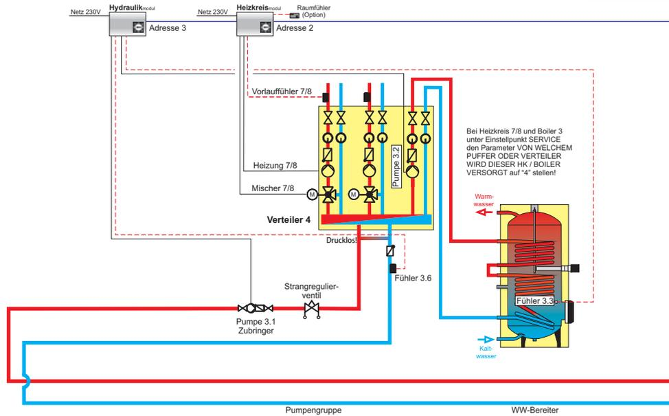
**Hinweis:** Im Menü NETZ PUMPE unter Punkt SERVICE den Parameter WELCHER FÜHLER WIRD FÜR DEN VERTEILER 4 VERWENDET auf "3.1" stellen. Im Menü WASSER bei BOILER 3 unter Einstellpunkt SERVICE den Parameter WELCHER FÜHLER WIRD FÜR DEN BOILER 3 VERWENDET auf "3.3", WELCHE PUMPE WIRD FÜR DEN BOILER 3 VERWENDET auf "3.2" stellen.
