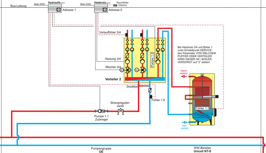
**Hinweis:** Im Menü NETZ PUMPE unter Punkt SERVICE den Parameter WELCHER FÜHLER WIRD FÜR DEN VERTEILER 2 VERWENDET auf "1.1", WELCHE PUMPE WIRD FÜR DEN VERTEILER 2 VERWENDET auf "1.1" stellen. Im Menü WASSER bei BOILER 1 unter Einstellpunkt SERVICE den Parameter WELCHER FÜHLER WIRD FÜR DEN BOILER 1 VERWENDET auf "1.3", WELCHE PUMPE WIRD FÜR DEN BOILER 1 VERWENDET auf "1.2" stellen.
