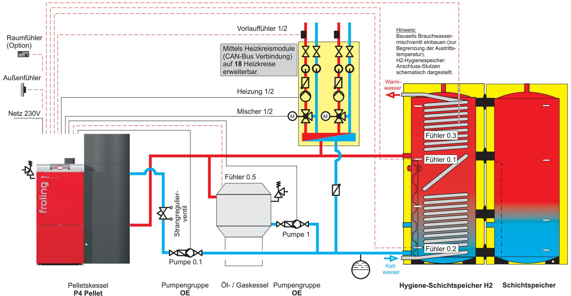
**Hinweis:** Bei Einsatz eines Schichtspeichers ist im Menü KESSEL unter Punkt SERVICE der Parameter GLEITENDER BETRIEB AKTIV auf "NEIN" zu stellen!
