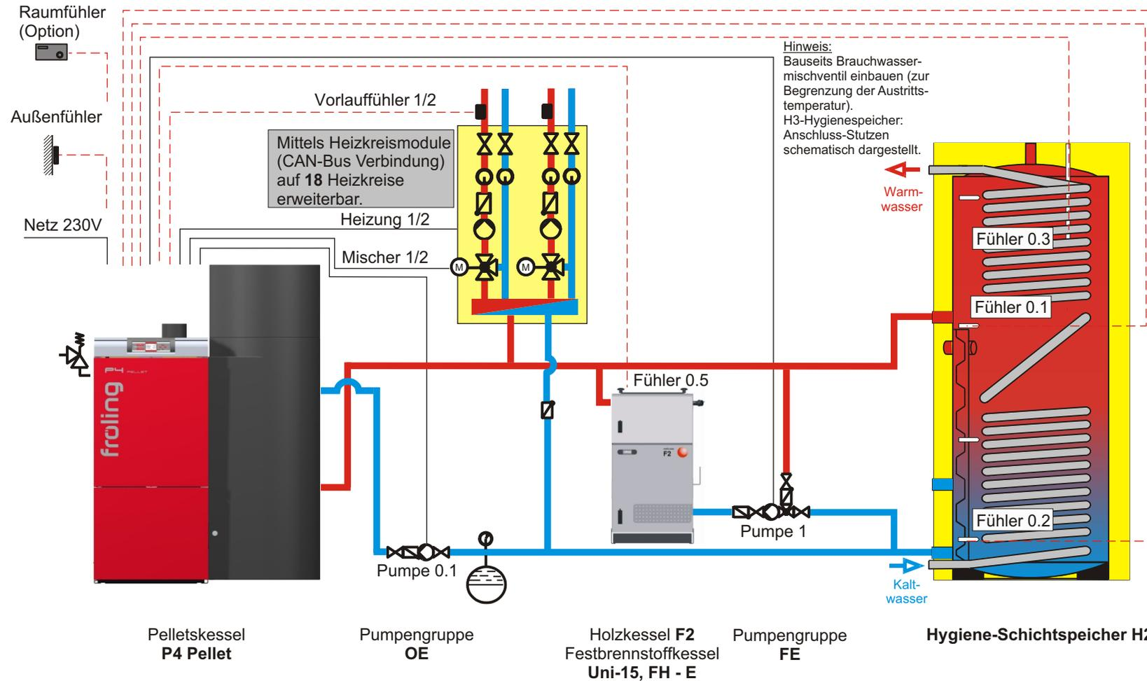
**Hinweis:** Bei Einsatz eines Schichtspeichers ist im Menü KESSEL unter Punkt SERVICE der Parameter GLEITENDER BETRIEB AKTIV auf "NEIN" zu stellen!
