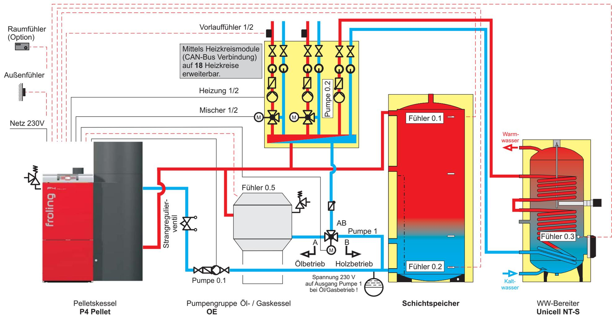
**Hinweis:** Im Menü KESSEL 2 unter Punkt SERVICE den Parameter WELCHER AUSGANG WIRD FÜR DIE FOLGEKESSELENTLADUNG VERWENDET auf "Pumpe 1" stellen.
