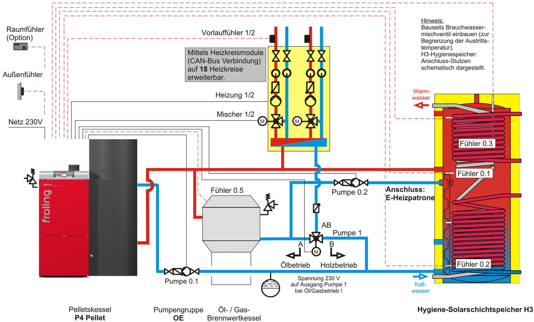
**Hinweis:** Im Menü KESSEL 2 unter Punkt SERVICE den Parameter WELCHER AUSGANG WIRD FÜR DIE FOLGEKESSELENTLADUNG VERWENDET auf "PUMPE 1" stellen!
