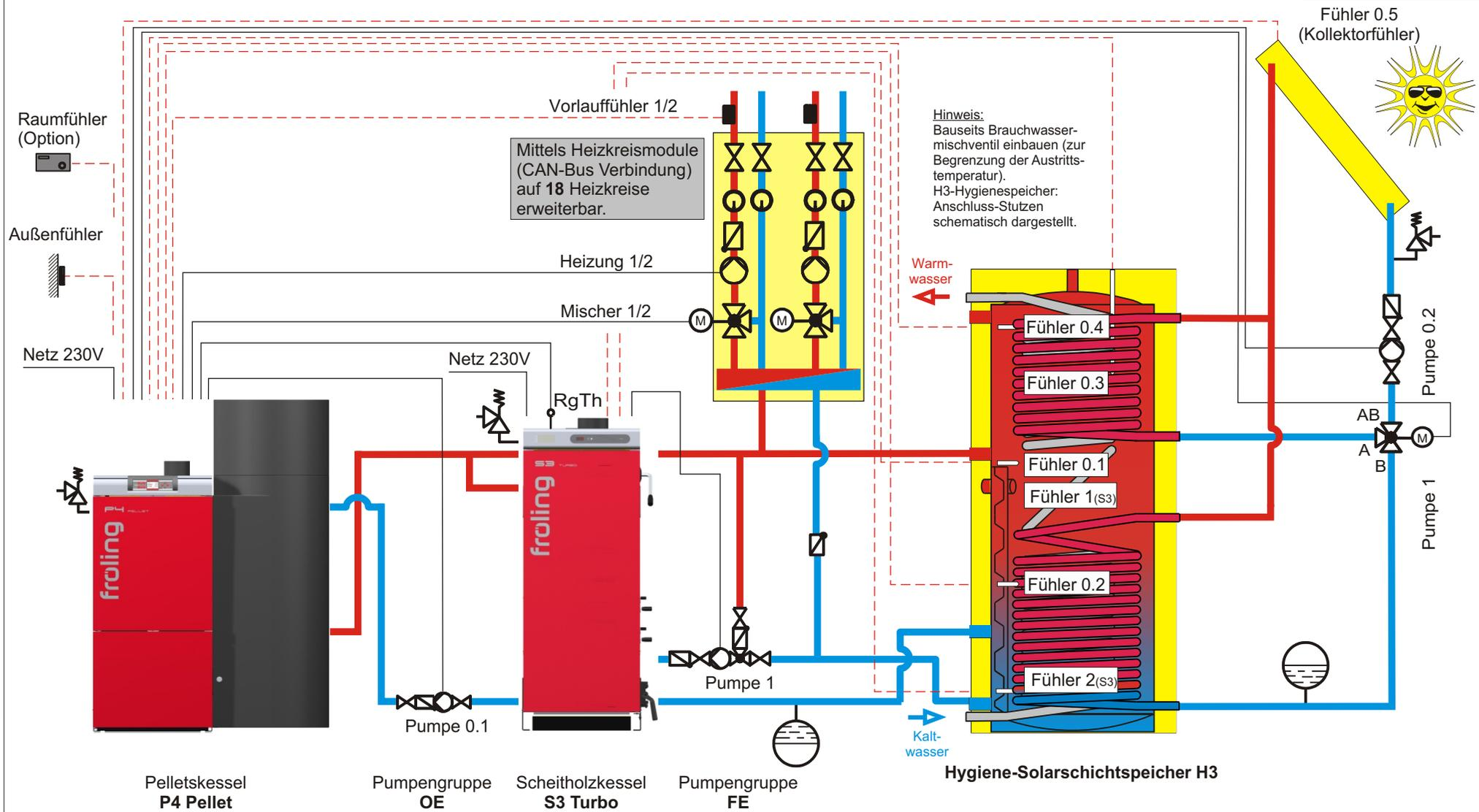
**Hinweis:** Bei Einsatz eines Schichtspeichers ist im Menü KESSEL unter Punkt SERVICE der Parameter GLEITENDER BETRIEB AKTIV auf "NEIN" zu stellen!
