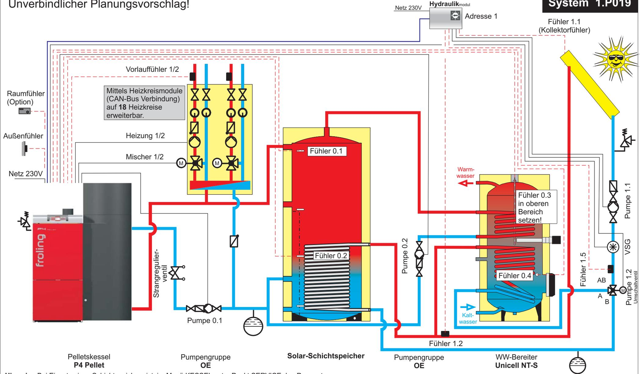
**Hinweis:** Bei Einsatz eines Schichtspeichers ist im Menü KESSEL unter Punkt SERVICE den Parameter GLEITENDER BETRIEB AKTIV auf "NEIN" zu stellen!
