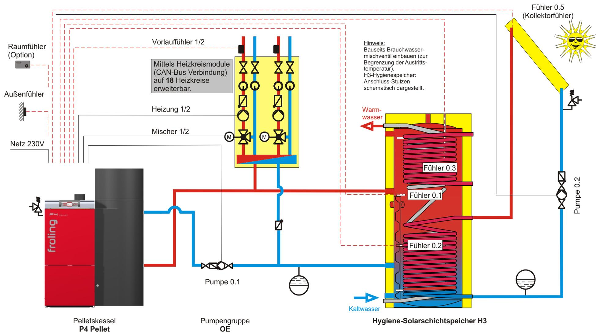
**Hinweis:** Bei Einsatz eines Schichtspeichers (Hygienspeicher H3, Schichtspeicher) ist im Menü KESSEL unter Punkt SERVICE der Parameter GLEITENDER BETRIEB AKTIV auf "NEIN" zu stellen! Im Menü SOLAR bei Einstellpunkt SOLAR die Parameter SOALR SYSTEM auf "2", WELCHER FÜHLER WIRD FÜR DEN SOLARKOLLEKTOR VERWENDET auf "0.5", WELCHE PUMPE WIRD FÜR DEN SOLARKOLLEKTOR VERWENDET auf "0.2" stellen. Regelung P3200
