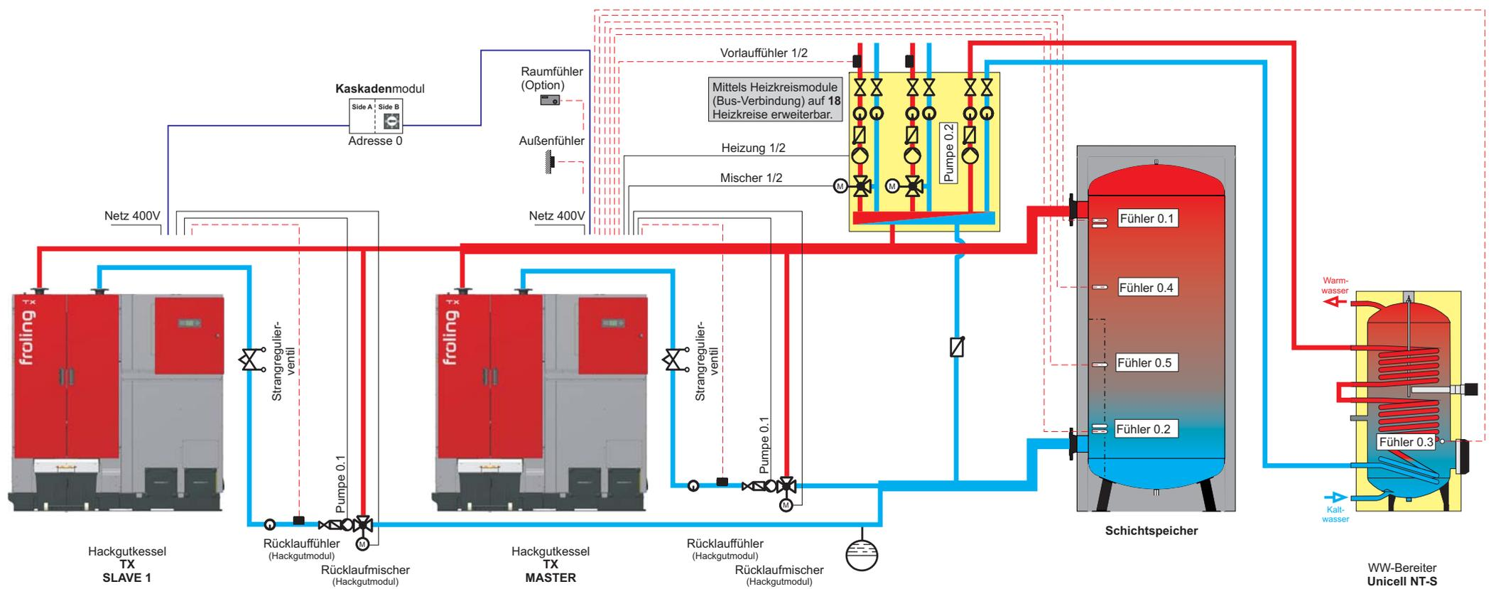
**Hinweis:** Bei beiden Kesseln ist der Parameter AUTOMATISCHE KESSELABSCHALTUNG WENN KEINE WÄRMEANFORDERUNG auf "JA" zu stellen.
