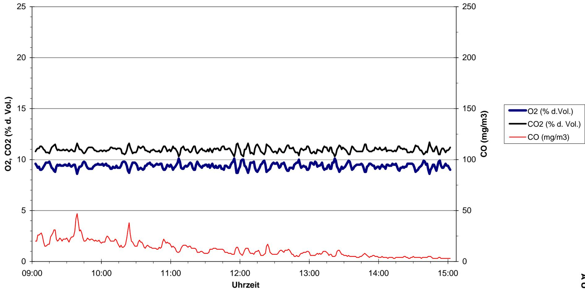
**Kesseltype TX 250 - Brennstoff Holzpellets - kleinste Wärmeleistung (Teillast)**
