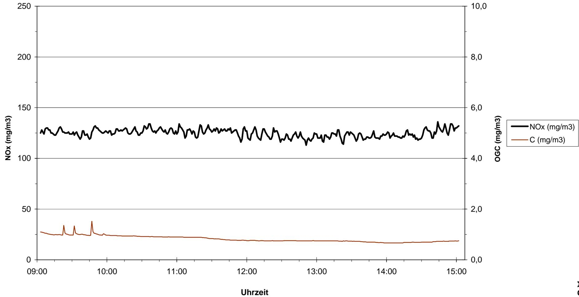
**Kesseltype TX 250 - Brennstoff Holzhackgut - Nennlast**
