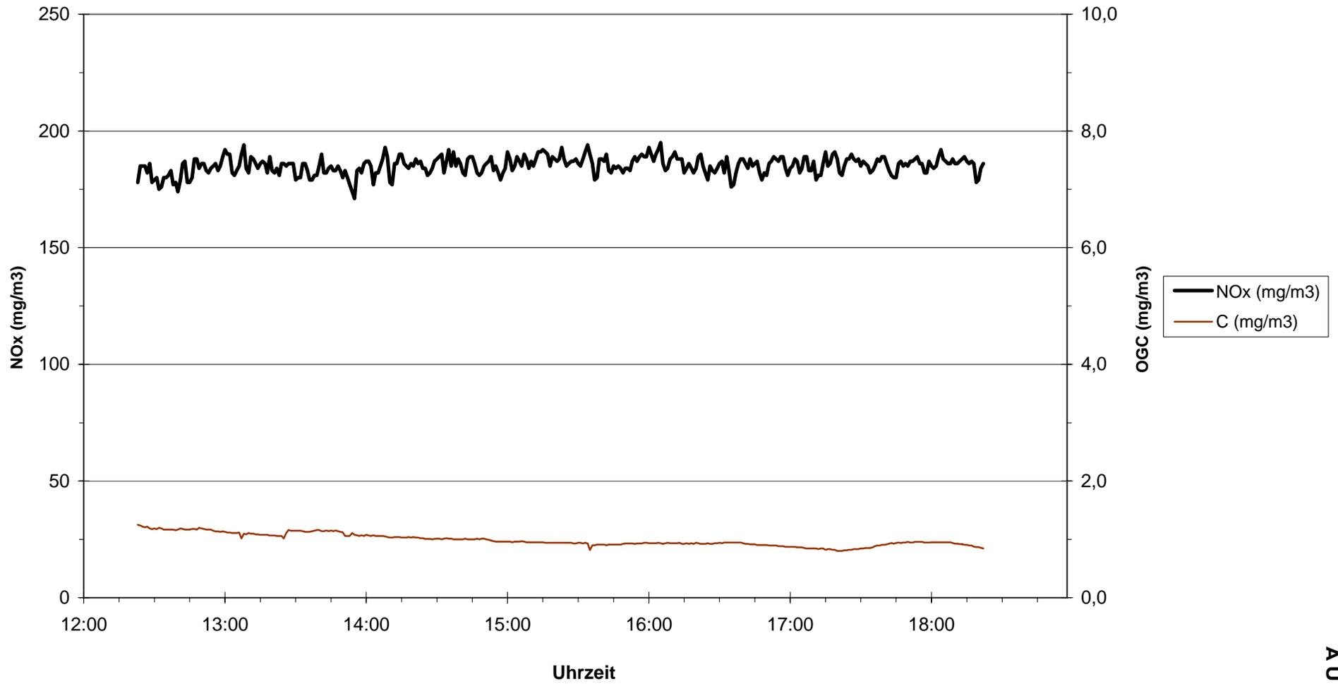
**Kesseltype TX 250 - Brennstoff Holzpellets - kleinste Wärmeleistung (Teillast)**
