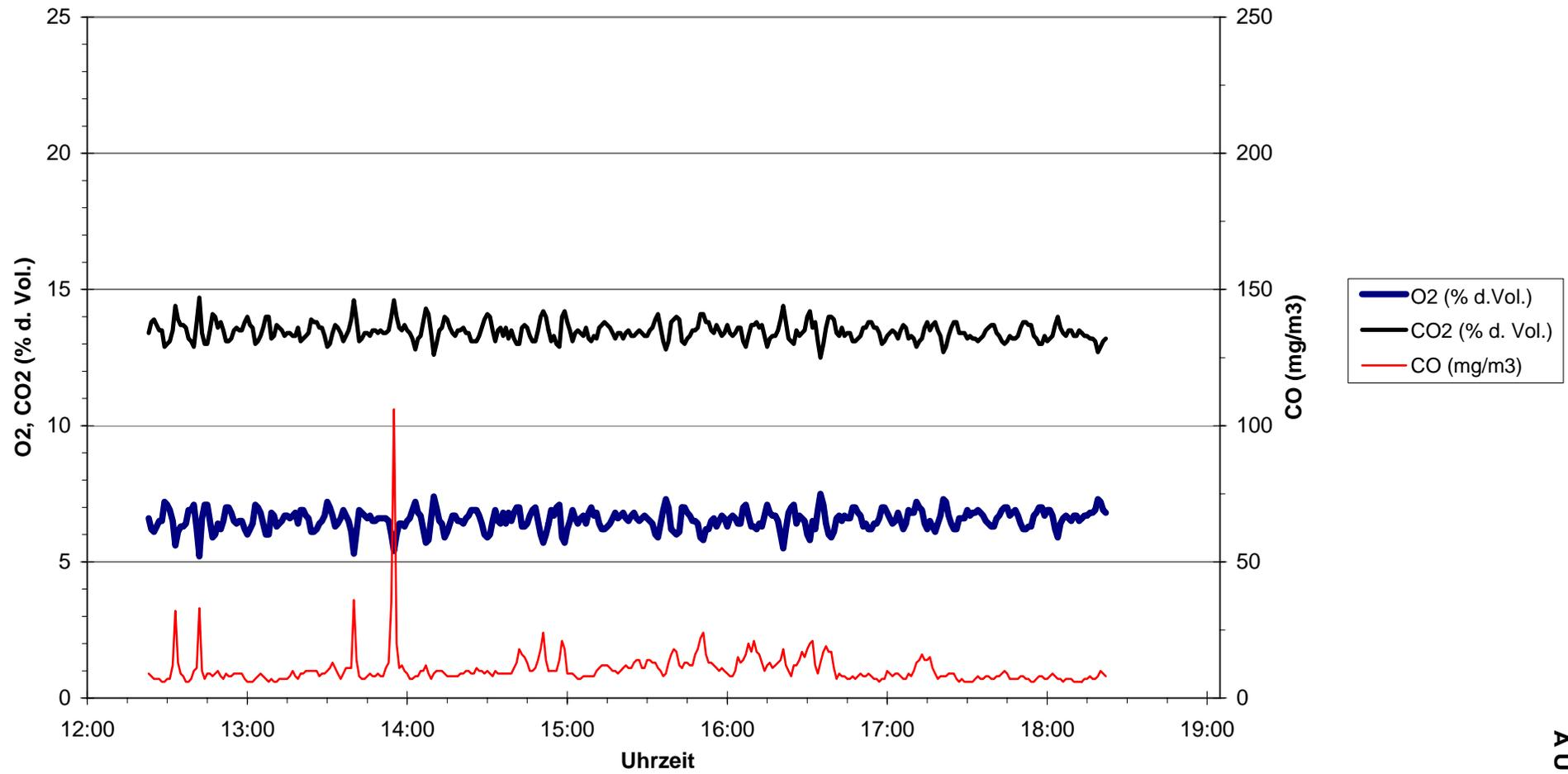
**Kesseltype TX 250 - Brennstoff Holzpellets - Nennlast**
