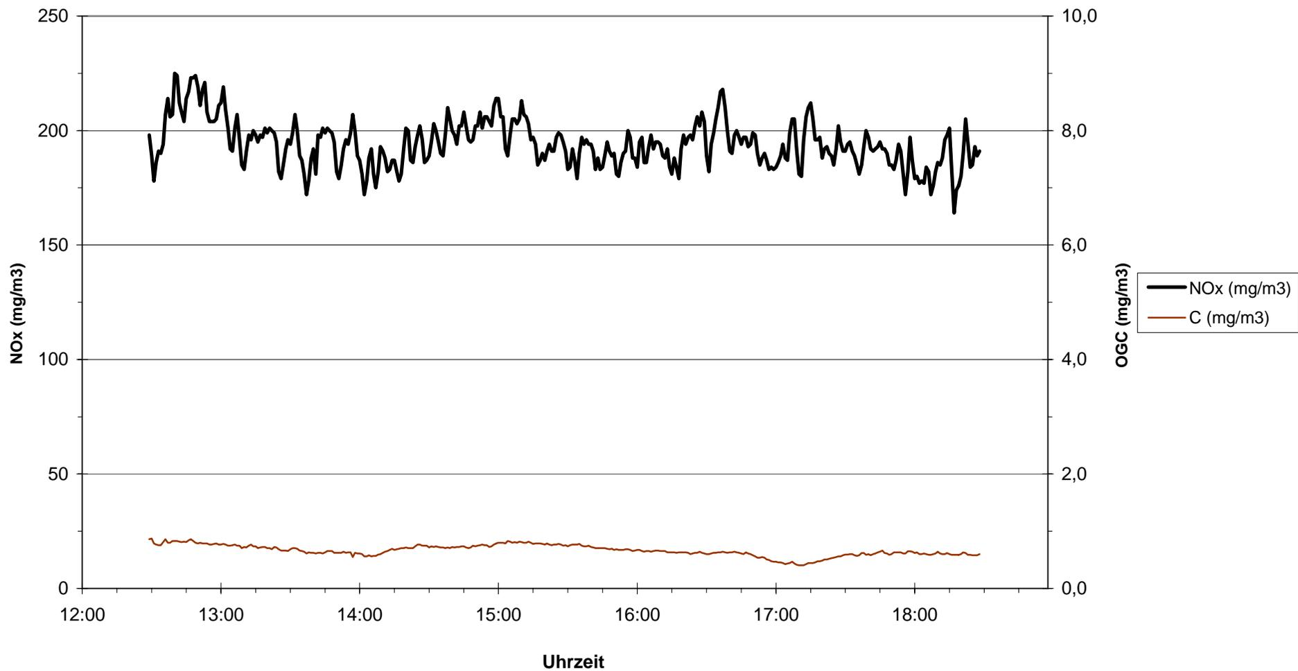
**Kesseltype TX 250 - Brennstoff Holzhackgut - kleinste Wärmeleistung (Teillast)**
