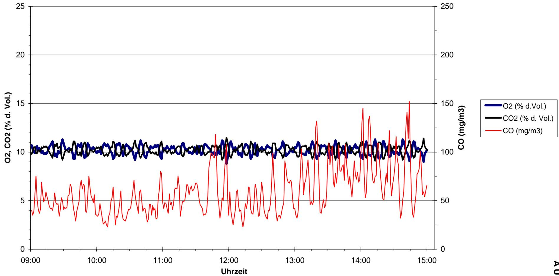
**Kesseltype TX 250 - Brennstoff Holzhackgut - kleinste Wärmeleistung (Teillast)**
