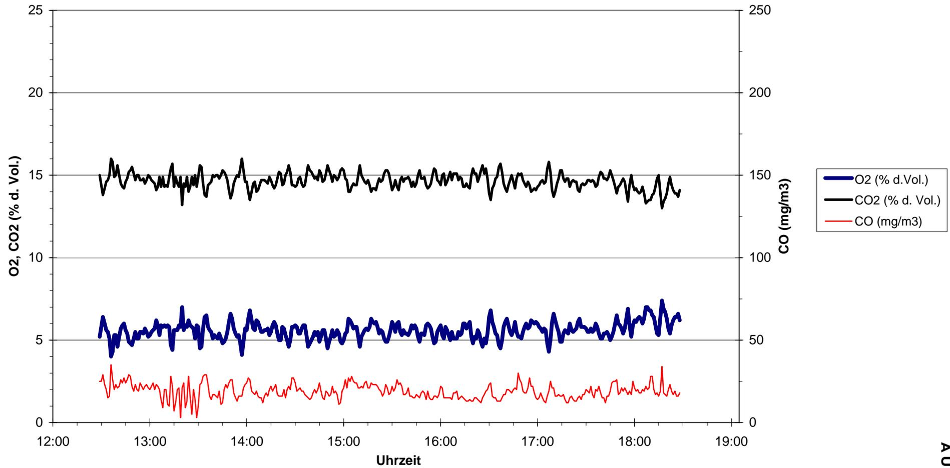
**Kesseltype TX 250 - Brennstoff Holzhackgut - Nennlast**
