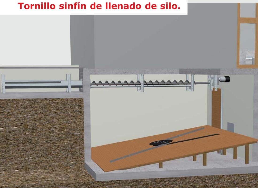
El tornillo sinfín de llenado de silo transporta el combustible al silo de forma correcta y se detiene automáticamente cuando el silo está lleno.
