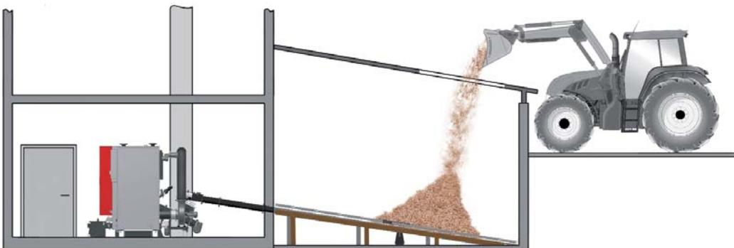
El silo está situado en el exterior debajo del nivel de acceso. El combustible se vierte en el silo desde arriba. Por lo general, el silo de almacenamiento de combustible es una construcción anexa de costo reducido.
