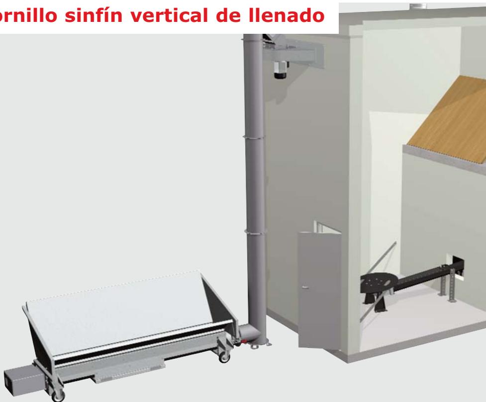
El tornillo sinfín vertical de llenado marca nuevas pautas en capacidad de transporte ( $45 \text{ m}^3/\text{h}$ ), seguridad de funcionamiento y nivel de llenado del silo. Las astillas se introducen en el transportador por medio de un sinfín desde el canal de recepción y el combustible se transporta al disco de centrifugado a la altura deseada. El sinfín vertical facilita un llenado del silo libre de polvo y permite una distribución uniforme del combustible en el silo.
