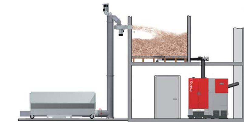
El silo está situado encima de la sala de la caldera. El combustible se introduce en la caldera a través de un tubo de caída por gravedad. Aquí es recomendable utilizar una válvula rotativa. El silo se puede llenar con comodidad utilizando el tornillo sinfín vertical de alimentación o inyectando el combustible.
