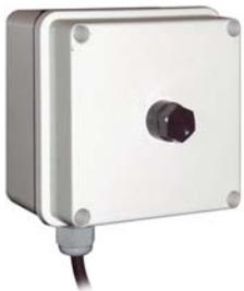
El termostato de seguridad (STB) desconecta la caldera a una temperatura de aprox. 100°C. Una vez que la temperatura haya descendido por debajo de aprox. 75 °C, el termostato de seguridad se puede desbloquear mecánicamente.
