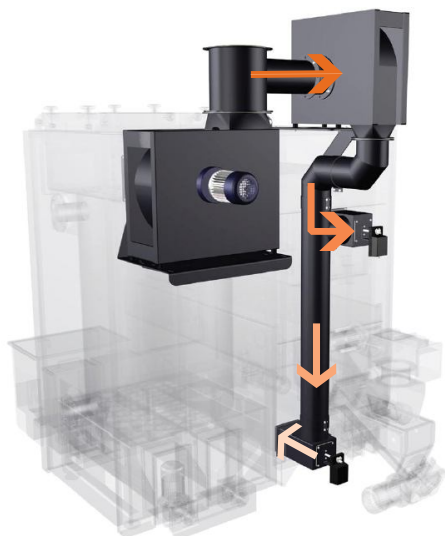
Sistema de recirculación de humos de la caldera Froling Turbomat en el que se aprecian los dos servomotores que controlan la inyección en los niveles de combustión primaria y terciaria.
