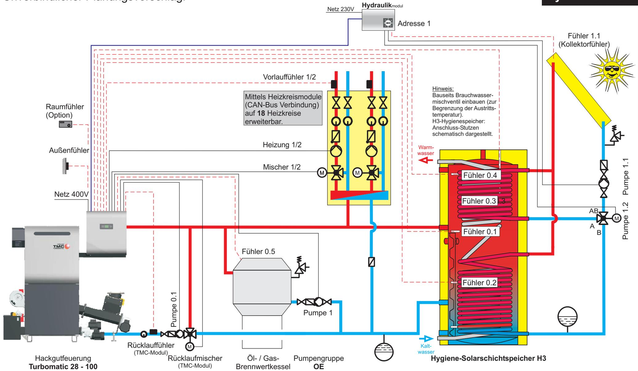
**Hinweis:** Im Menü KESSEL 2 unter Punkt SERVICE den Parameter WELCHER AUSGANG WIRD FÜR DIE FOLGEKESSEL ENTLADUNG VERWENDET auf "Pumpe 1" stellen!
