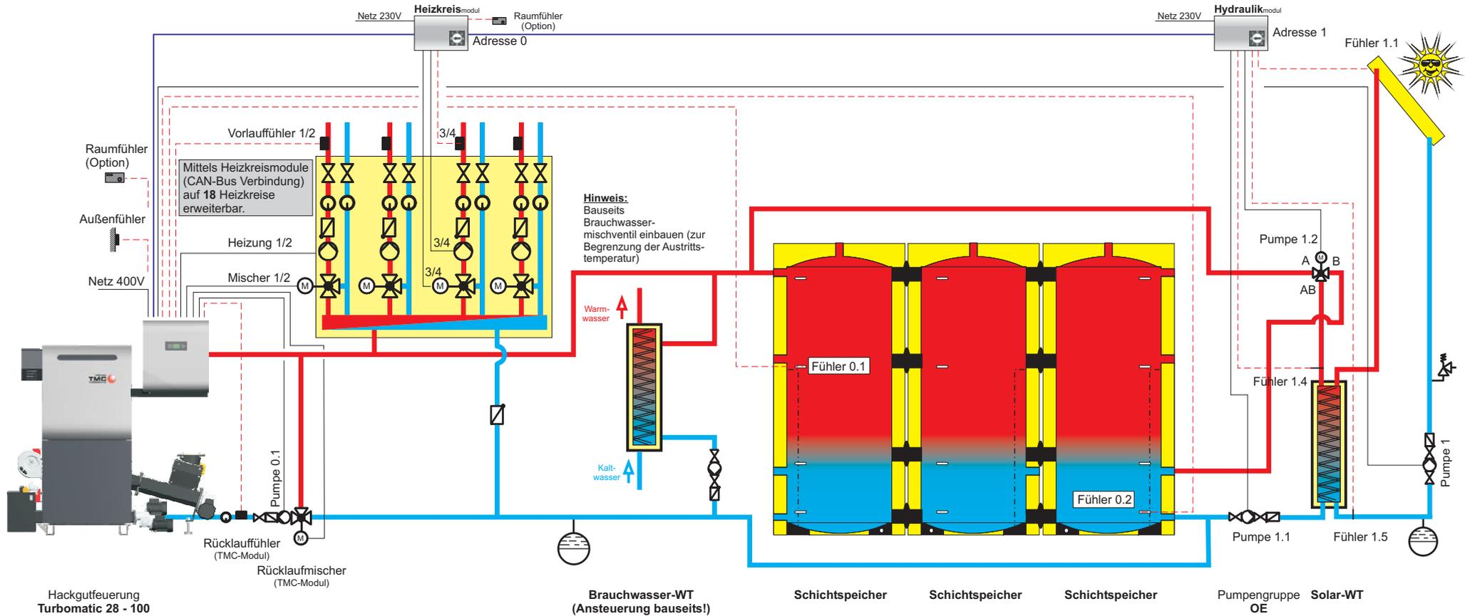
**Hinweis:** Im Menü SOLAR bei Einstellpunkt SERVICE den Parameter WELCHE PUMPE WIRD FÜR DEN SOLARKOLLEKTOR VERWENDET auf "Pumpe 1", WELCHE PUMPE WIRD FÜR PUFFER - WÄRMETAUSCHER VERWENDET auf "1.1" stellen. Ventil stromlos AB-B, Regelung H3200
