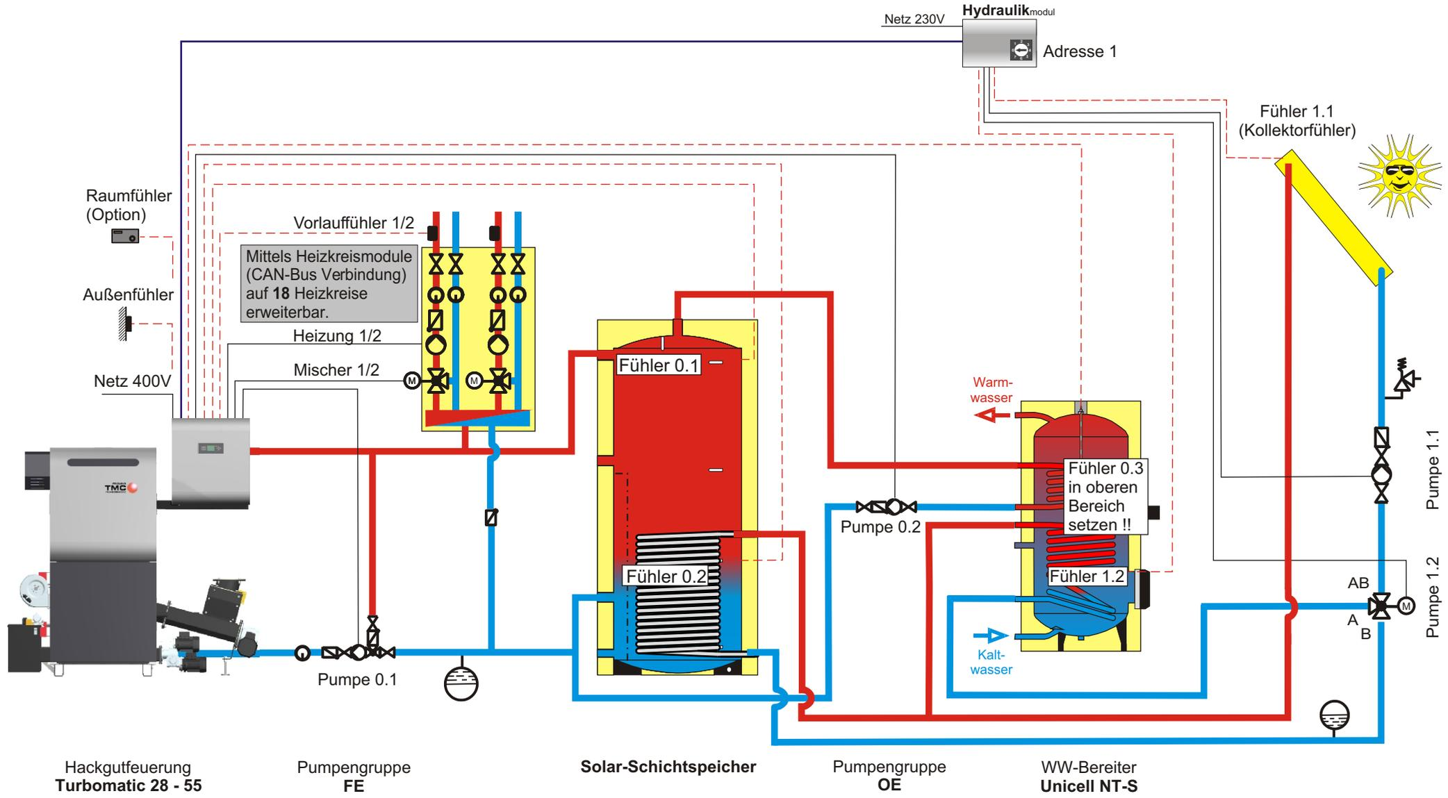
**Hinweis:** Im Menü SOLAR bei Einstellpunkt SERVICE den Parameter SOLAR SYSTEM auf "3" und WELCHER FÜHLER WIRD FÜR DEN BOILER UNTEN VERWENDET auf "1.2" stellen. Regelung H3200.
