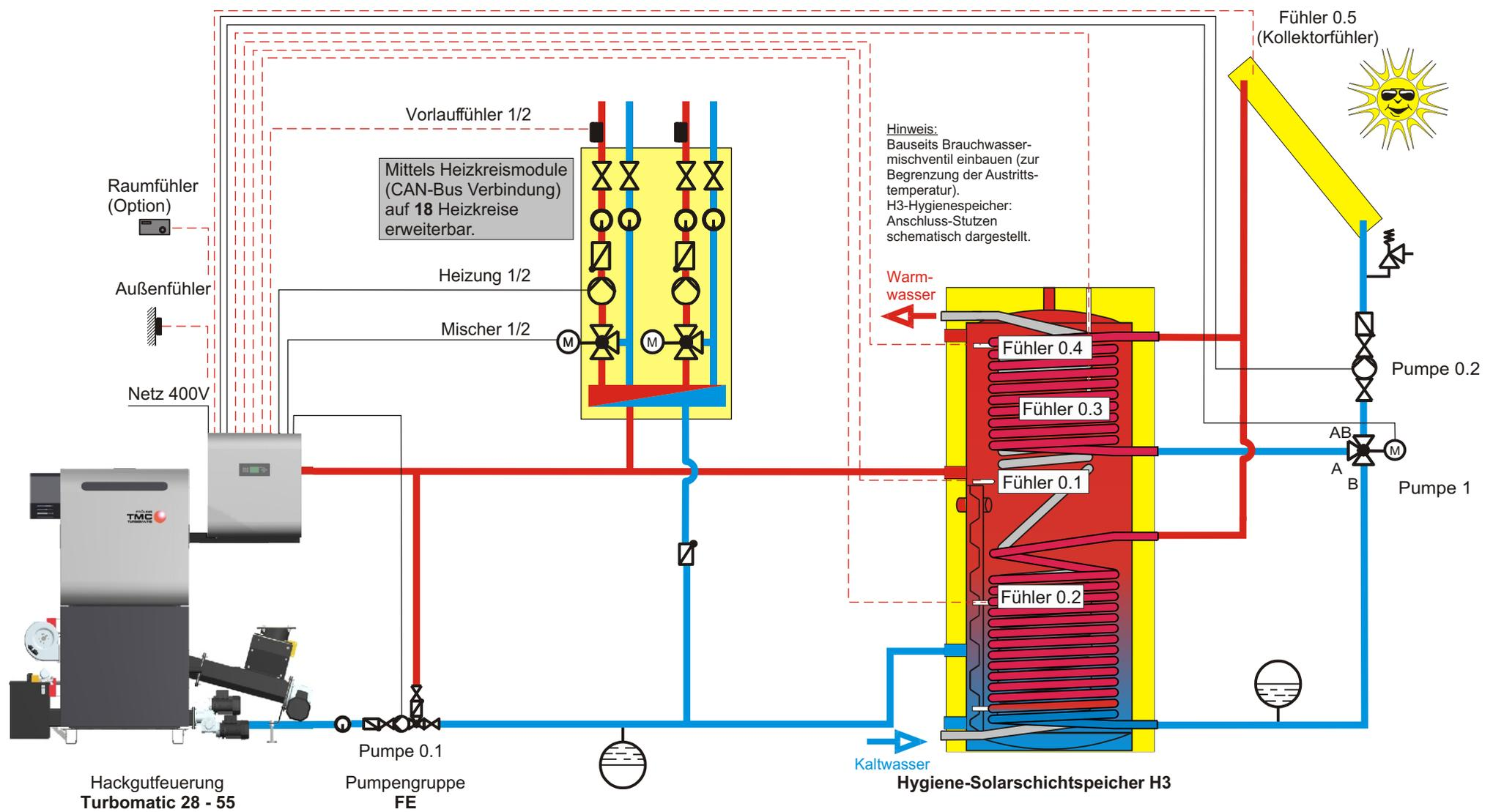
**Hinweis:** Im Menü SOLAR bei Einstellpunkt SERVICE die Parameter SOLAR SYSTEM auf "3", WELCHER FÜHLER WIRD FÜR DEN SOLARKOLLEKTOR VERWENDET auf "0.5", WELCHE PUMPE WIRD FÜR DEN SOLARKOLLEKTOR VERWENDET auf "0.2", WELCHE PUMPE WIRD FÜR SOLARUMSCHALTVENTIL VERWENDET auf "Pumpe 1", stellen. Regelung H3200. Ab Softwareversion **V50.04 B04.08!**
