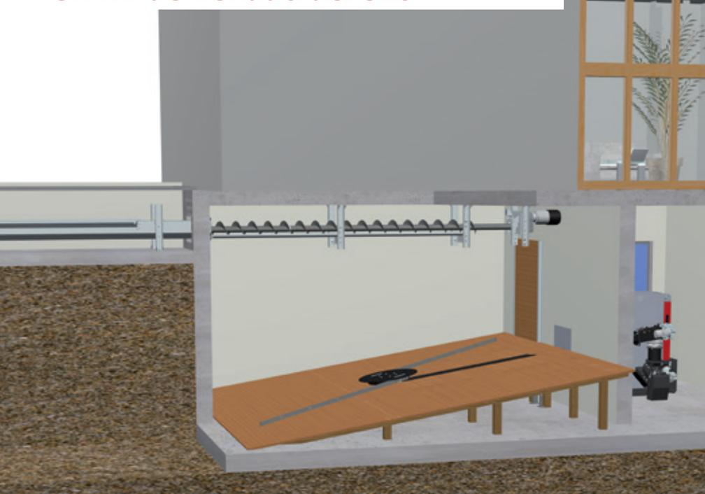
El sinfín de llenado del silo transporta el combustible hasta el silo de forma fiable y se detiene automáticamente cuando el silo está lleno.
