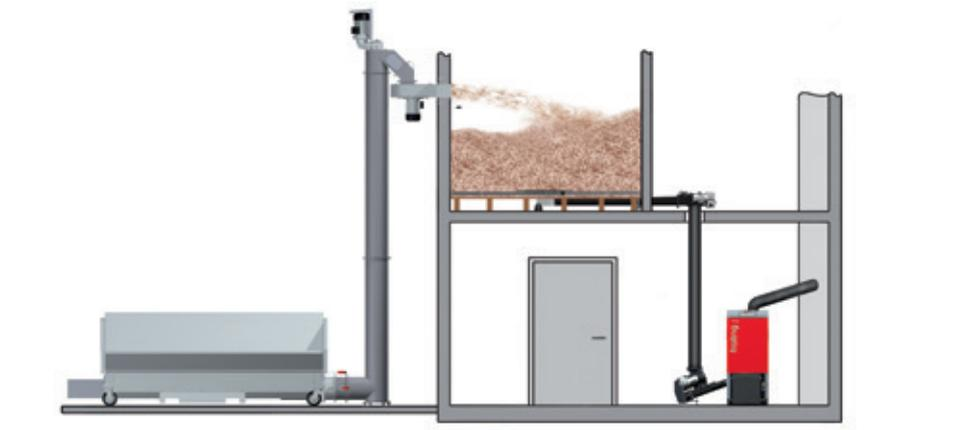
El silo está situado encima de la sala calderas. El combustible se introduce en la caldera a través de un tubo de caída por gravedad. La válvula rotativa obligatoria ya está incluida en el suministro de serie. El silo se puede llenar con comodidad utilizando el tornillo sinfín vertical de llenado o inyectando el combustible.
