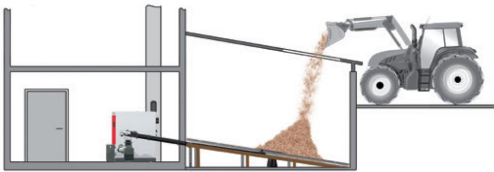
El silo está situado debajo del nivel de acceso. El combustible se descarga en el silo desde arriba. Por lo general, el silo de combustible es una construcción anexa de coste reducido. Desde un punto de vista técnico, el entrepiso que se muestra en la figura no es estrictamente obligatorio.
