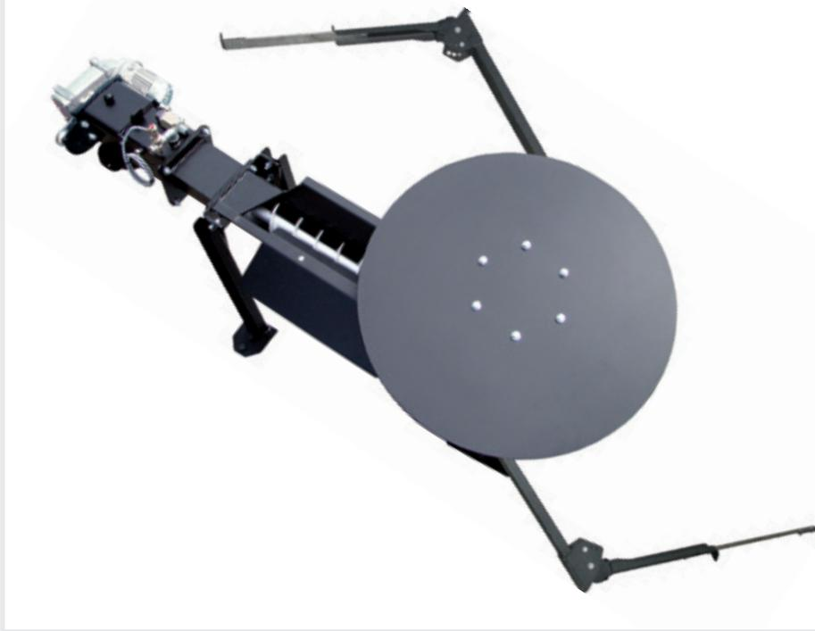
Para extraer astillas de silos con un diámetro máximo de 6,0 metros. Este sistema requiere poco mantenimiento y está diseñado específicamente para combustibles que exigen una alta capacidad de extracción debido a su baja fluidez. Su diseño patentado garantiza un funcionamiento silencioso y eficaz.
